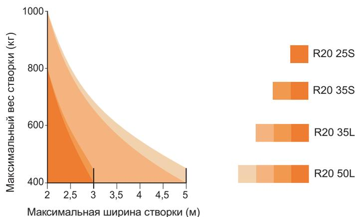
На графике показаны пределы использования привода по массе и ширине створки ворот. При ширине створки более 2,5 м рекомендуется использовать электрозамок.
