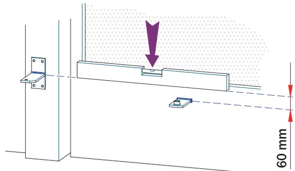
3. Проверьте горизонтальность кронштейна с помощью строительного уровня.
