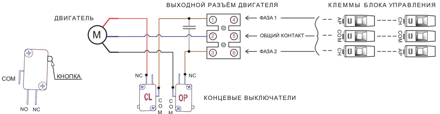
В состав привода входят два концевых выключателя (OP, CL), размещённых в пазу, выполненном в верхней части корпуса и защищённых крышкой. Быстрая регулировка конечных положений хода ворот осуществляется простым перемещением каретки выключателя до точки срабатывания. Действуйте согласно рисунку:
